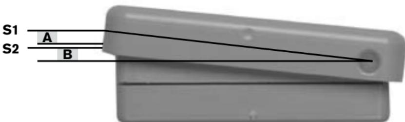
Ao premir o comutador basculante alcança-se o primeiro ponto de ligação (S1) e o sinal de comando A é interligado.
