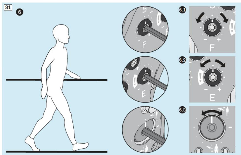
32: Los movimientos mostrados en la ilustración entrañan riesgo de caídas, ya que pueden desactivar la resistencia de flexión en la fase de apoyo.
