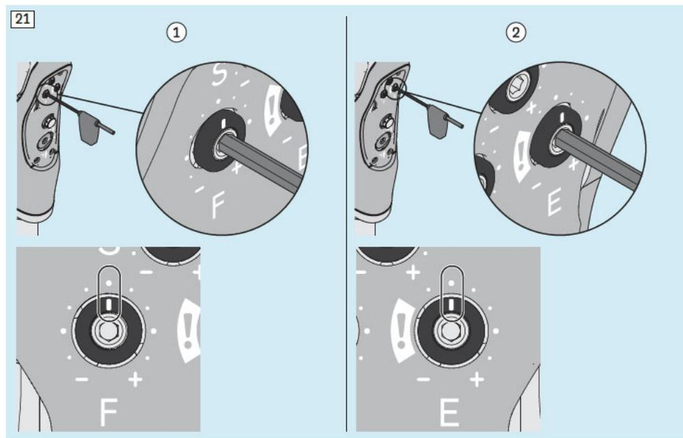
**22:** ①: Bloqueo (desactivado); ②: Resistencia de flexión de la fase de apoyo (activada)
