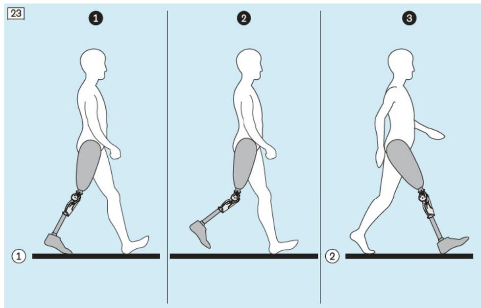
24: ①: Riesgo de caídas - Los movimientos pueden desactivar la resistencia de flexión en la fase de apoyo
