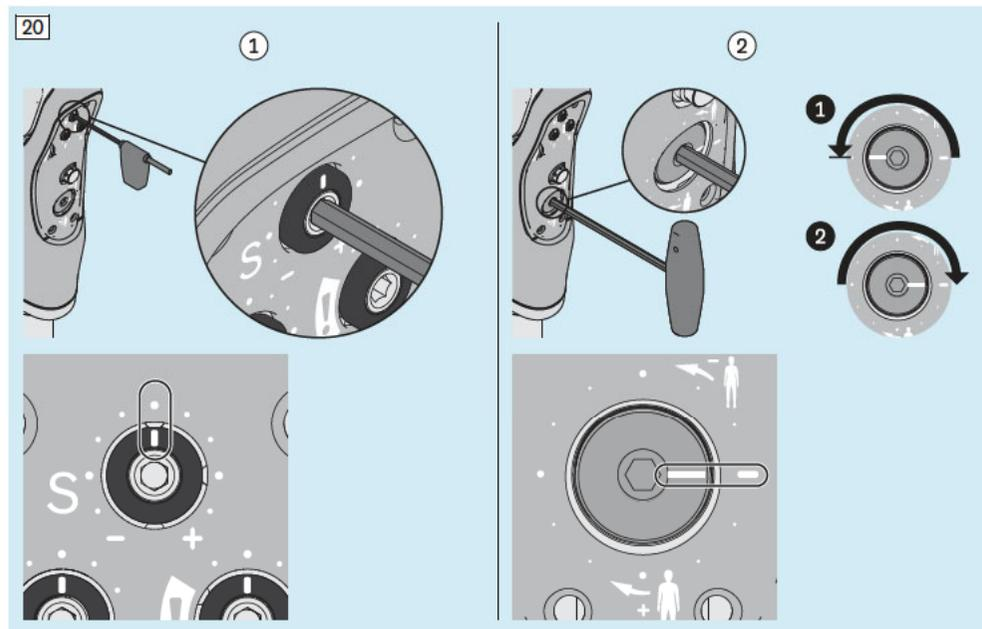
**21:** ①: Resistencia de flexión de la fase de balanceo; ②: Resistencia de extensión de la fase de balanceo
